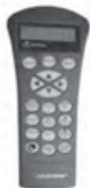
StarSense Hand-Controller mit 32-Bit-Prozessor
