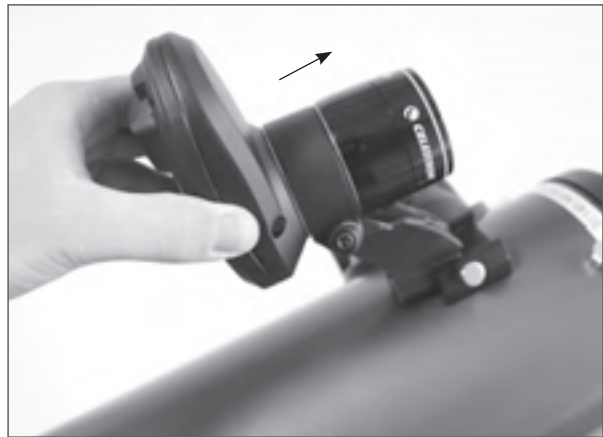
Befestigen mit der kleinen Basis (von hinten nach vorne)
