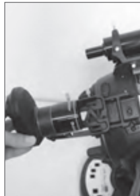
Basis und Sucherschuh umgekehrt montiert
