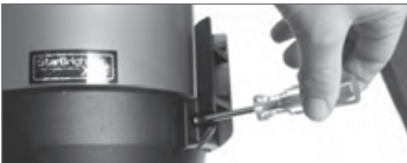
Befestigen der Sucherbasis mit einem Kreuzschlitzschraubenzieher
